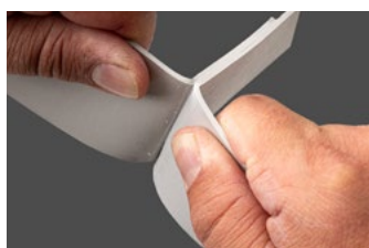
Prova di pelatura (striscia di 5 cm)
