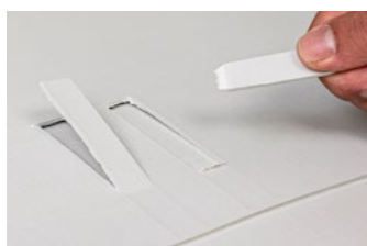
Prova di pelatura (2 cm con strappo all'esterno del giunto)
