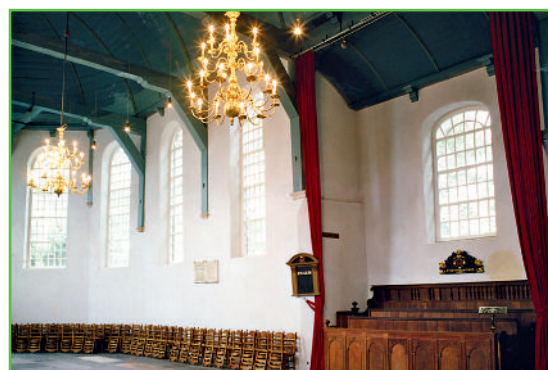
Le pareti interne di questi edifici sono stati risanati con KÖSTER Intonaco Risanante 2 White.
